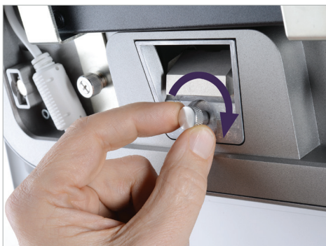
13. HD экранды қауіпсіз бекіту үшін, сканерді айналдырып, бұранданы бұрап, бекітіңіз
