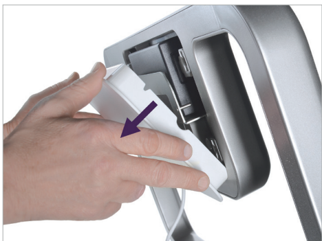
9. Дөңгелекті тіреуіш рамасының артқы жағынан магнитті қақпақты шешіңіз
