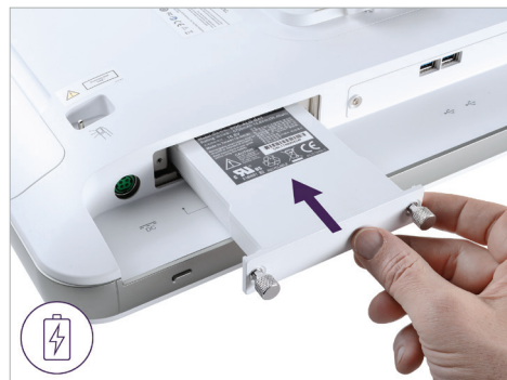
11. Батареяны батарея ұясына қондырып, бұрандаларды бұрап бекітіңіз
