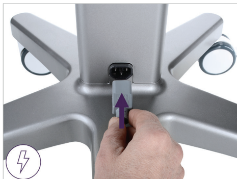
19. Қуат кабелін дөңгелекті тіреуіштің астыңғы жағына жалғаңыз
